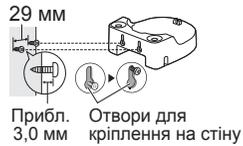
② Причепіть підставку для заряджання на стіну за допомогою відповідних отворів під гвинти на задній панелі та зафіксуйте її.
